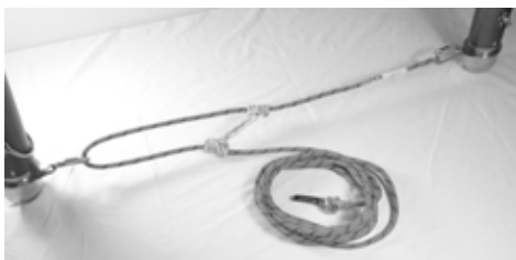
Figura 14 Bucle de cuerda de cojeo con Prusik. Bucle cosido conectado a enlace rápido; bucle grande conectado al enlace rápido de la segunda pata.
